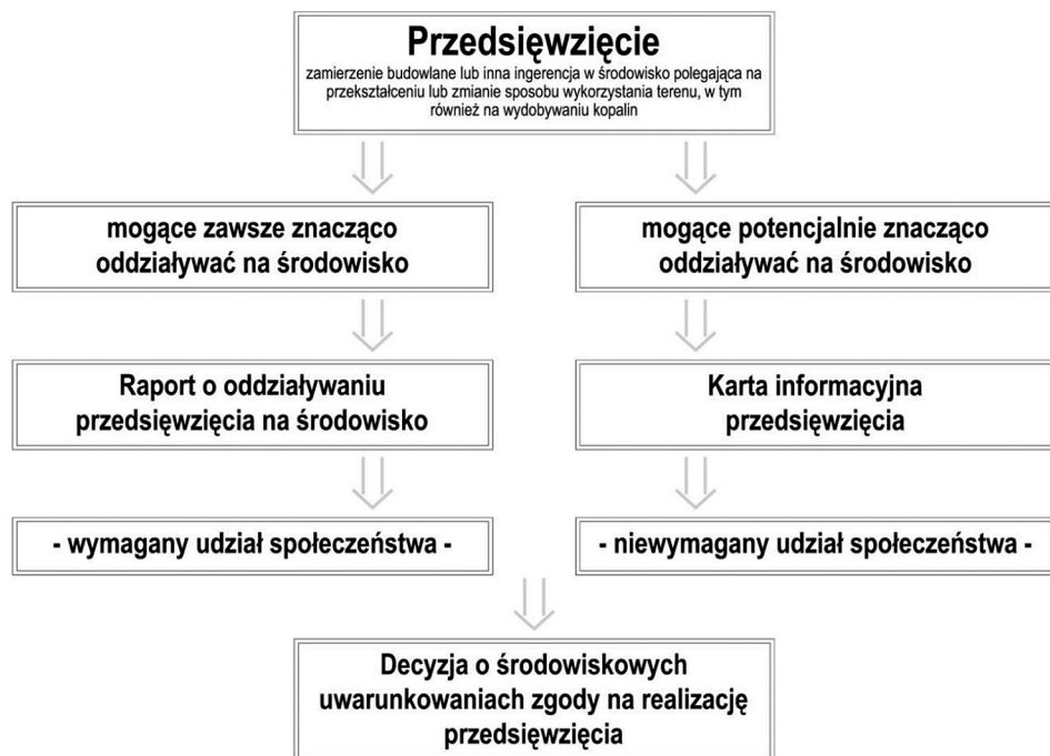
Ryc. 42. Procedura uzyskania decyzji o środowiskowych uwarunkowaniach w ramach oceny oddziaływania przedsięwzięcia na środowisko
